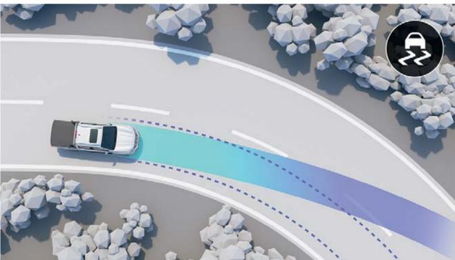
**control electrónico de estabilidad** corrige automáticamente la trayectoria de tu auto para evitar derrapes peligrosos
