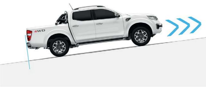
**asistencia de arranque en pendiente** mantiene la presión sobre el freno por dos segundos, lo que previene el retroceso cuando se quiere avanzar en una cuesta empinada
