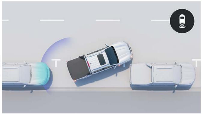
**sensores de estacionamiento traseros** asistencia ultrasónica para estacionar en reversa
