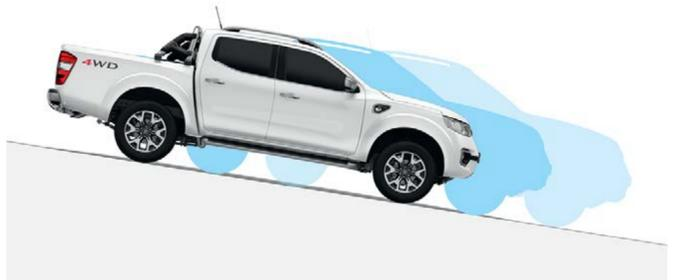
**control de descenso en pendiente** el sistema controla el descenso sin utilizar ni el freno ni el acelerador. solo te tenés que ocupar del volante
